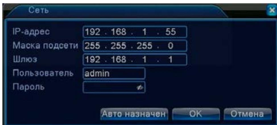
Рис. 42. Изменение сетевых настроек камеры
