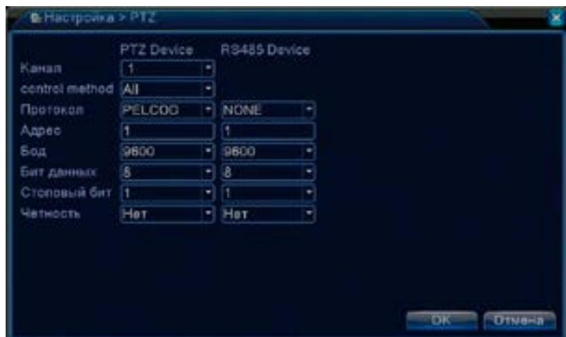
Рис. 44. Настройка PTZ (гибридный регистратор)
