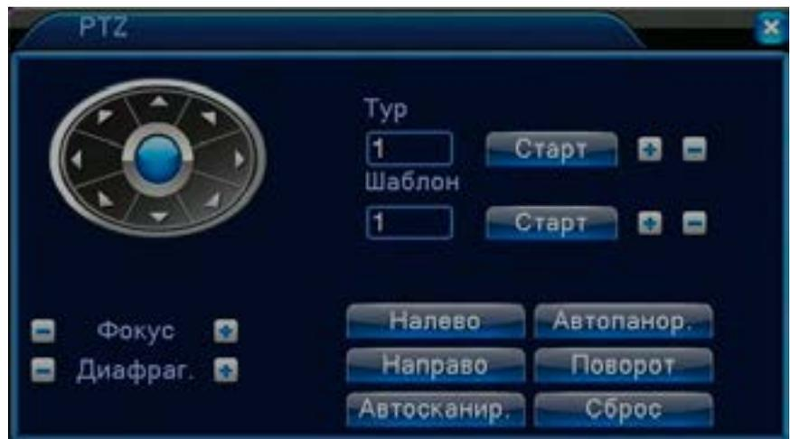
Рис. 47. Интерфейс управления PTZ
